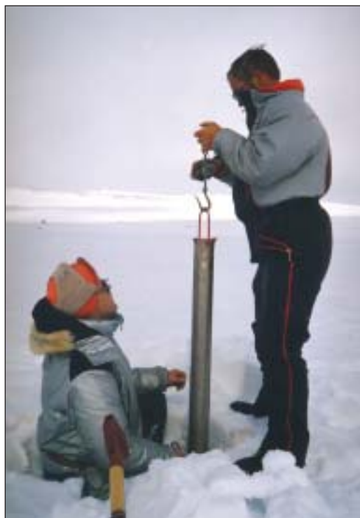
Øverst til høyre: Sylindren med snø skal veies. T.h. stikkstanga som var 2,5 m lang. Enkelte ganger strakk den ikke til, og da måtte målerne beregne snødybde. Øyvind Hagen t.v. Ola Grimsrud t.h. Halvor Skogen nede i hullet. Bildene er fra Sauarflot i Møsvassfeltet. (ØTBs arkiv)
